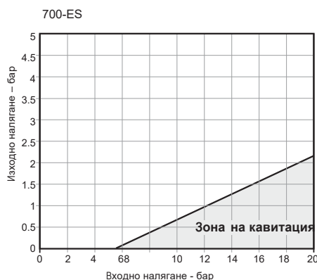
Диаграма Кавитация при диф. разлика до 12:1
